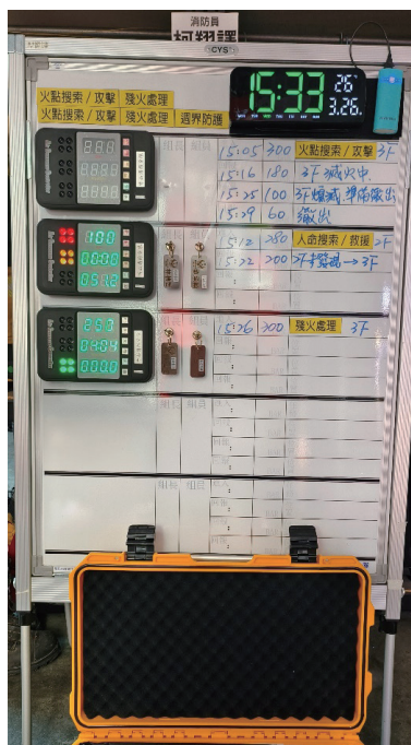
圖 19、第二小組出現紅、黃燈同時閃爍，安全幕僚要求小組長執行 PAR 回報的同時，也提醒小組注意剩餘壓力
