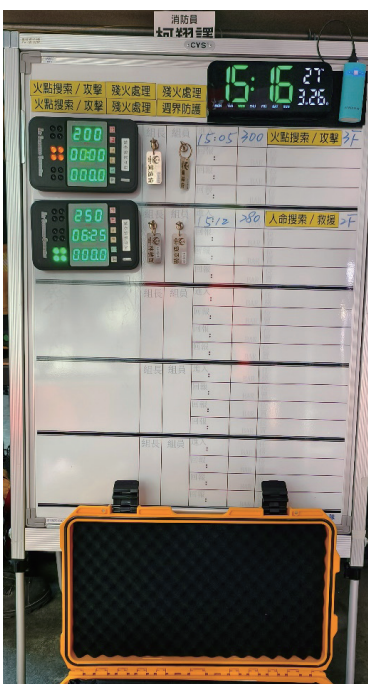
圖 10、第一小組入室人員 10 分鐘倒數歸零，此時黃燈閃爍、蜂鳴器啟動
