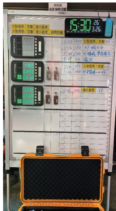
圖 18、第一小組於 15：29 撤出回到管制站，取回管制牌、將救命器插銷復位後，關閉管制器結束管制 (2)
