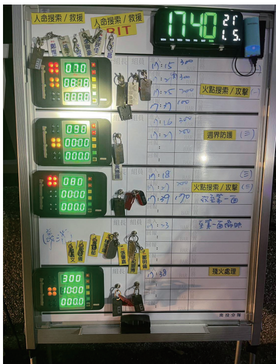
圖 23、為 114 年初在災害現場實際拍攝的管制板畫面歸零，此時黃燈閃爍、蜂鳴器啟動
