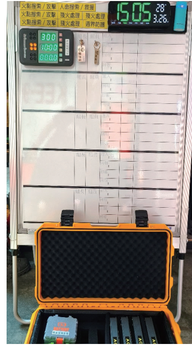
圖 6、按下 Start 鍵後，黃燈熄滅、綠燈長亮，第二格數字屏幕開始倒數計時
