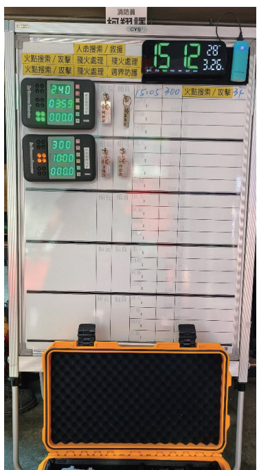
圖 8、全幕僚取出第二顆管制器磁吸於管制板，開機
