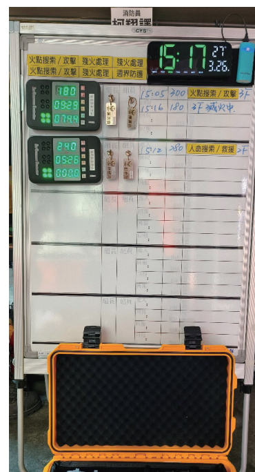
圖 12、安全幕僚可按 CALC 鍵，管制器自動計算即時耗氣量
