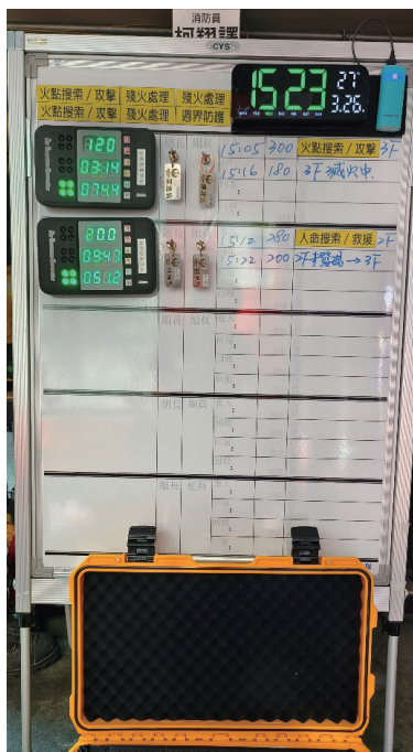
圖 14、藉由安全幕僚紀錄內容，可得知第二小組 15：22 回報最低氣量 200 Bar
