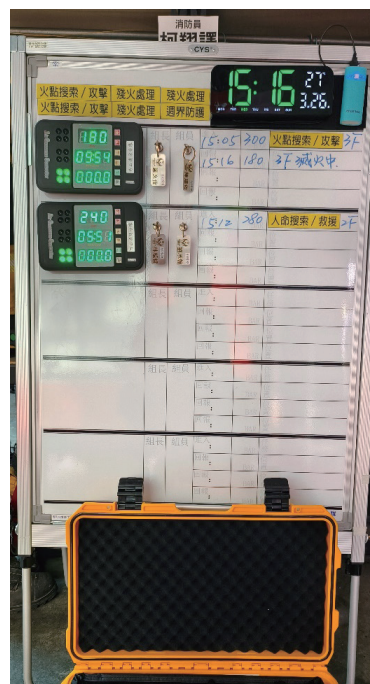
圖 11、按下 Reset 復歸至 10:00 後，按下 Start 開始新一輪管制
